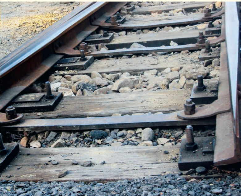
對開式轉轍器(左圖)與古樸的鐵道釘。圖 | 蕭英勵攝
